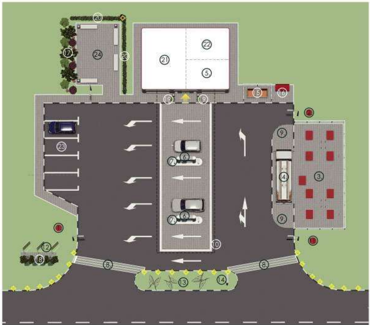
Тип 1.2. Схема планировочной организации придорожной автомобильно-заправочной станции
